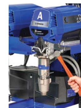
1. Desserrez le contre-écrou
