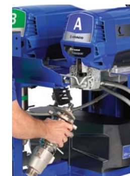
3. Retirez le tuyau et faites glisser la pompe
