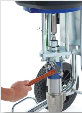
2. Loosen jam nut
