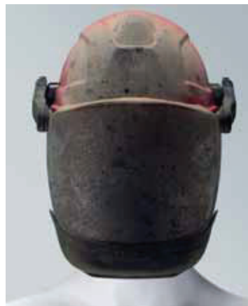
Après un arc électrique de 7 kA
