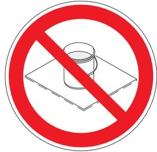
**Les seaux métalliques doivent toujours être mis à la terre :** raccorder un fil de terre au seau. Fixer une extrémité au seau et l'autre extrémité à une prise de terre telle qu'un tube de l'eau.
