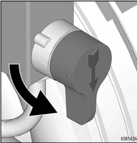
7. Tourner le bouton de régulation de pression sur le minimum.
