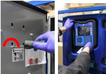
Ouvrez la trappe située derrière l'ADM en retirant l'unique vis, à l'aide d'une clé à six pans 3/8. Refermez la porte.
