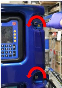
Démontez l'ADM en desserrant, avec un petit tournevis cruciforme, les vis situées derrière la porte sans les retirer, et en le soulevant l'ADM légèrement.
