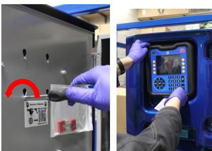
Puis ouvrez la trappe située derrière l'ADM en retirant l'unique vis, à l'aide d'une clé à six pans 3/8.
