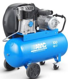
Compresseur à pistons lubrifié avec cylindre en fonte - Fonctionnement à basse température - Réservoir 100 litres - Débit d'air 17,1 m³/h - Puissance 3 CV - 230 V Mono
