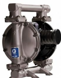
Pompe de transfert Husky 1050 côté ISO - Débit maximum 189 l/min - Bille en acier inoxydable - Section centrale et section fluide en aluminium - Vanne d'air à faible pulsation - Maintenance réduite
