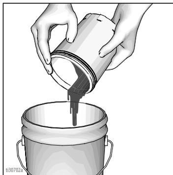
5. Il est recommandé de mettre au rebut l'ancien FlexLiner (4) et d'en installer un nouveau. En cas de réutilisation, nettoyez en essuyant tous les excès de liquide du FlexLiner (4).
