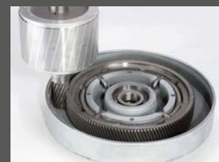
Transmission par roue dentée métallique
