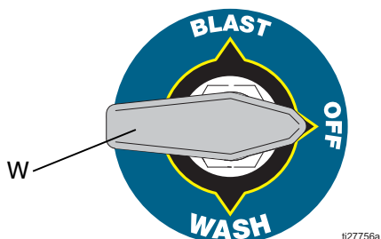
FIG. 1 : Tournez la vanne de sélection sur OFF (Arrêt)
