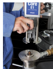
3. Faire glisser le moteur électrique pour le retirer
