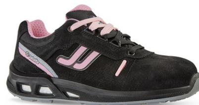
Modèle féminin - Tige cuir nubuck souple hydrofuge et textile déperlant - Embout de sécurité aluminium - Semelle anti-perforation non métallique - Doublure tige respirante maille 3D - Niveau de protection S3 CI SRC
