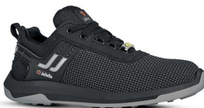
Style urban sport - Tige en PUTEK PLUS hautement résistant à l'abrasion - Embout de sécurité aluminium - Semelle anti-perforation non métallique - Doublure maille 3D - Niveau de protection S3 CI SRC
