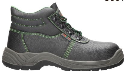
Tige en cuir de bovin et résistante à l'eau - Semelle d'usure résistante aux huiles et carburants, à la chaleur de contact jusqu'à 110°C - Embout et semelle anti-perforation en acier - Protection S3 SRA
