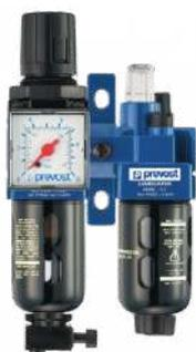
Ensemble de filtration d'air G 1/4 : Filtre régulateur lubrificateur 2 blocs avec manomètre et fixation, G 1/4, 500 l/min à 7 bar
