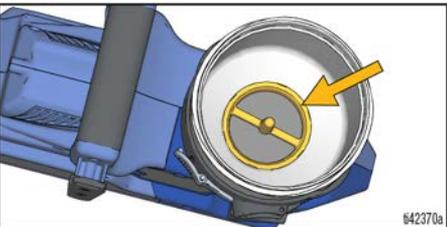
7. Remplir à moitié le réservoir de liquide de nettoyage, voir **Compatibilité des liquides de nettoyage**, page 26 et replacer le couvercle du réservoir. Vérifier que le bouchon de stockage est OUVERT.
