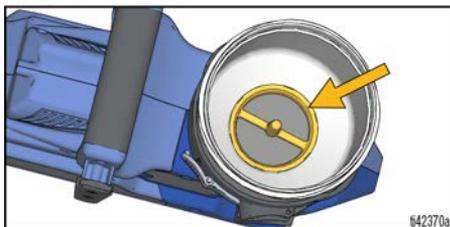
4. Remplir le réservoir de peinture et replacer le couvercle du réservoir.
