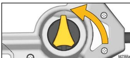
3. Retirer le pulvérisateur de la ceinture en appuyant sur le clip de desserrage de l'étui et tirer sur le pulvérisateur.
