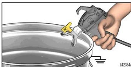
6. Tourner le bouton d'amorçage vers l'avant en position SPRAY.
