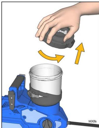
3. Vérifier qu'un filtre de pompe propre soit installé au fond du réservoir, à l'entrée de la pompe. Utiliser le filtre noir de 60 mailles avec des peintures et le filtre bleu de 100 mailles avec des colorants et des produits minces.
