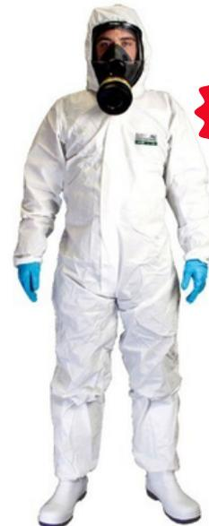
Tissu laminé microporeux 55 g/m<sup>2</sup> - Zip à double sens - Sans silicone ni latex - Propriétés antistatiques - Protection contre les éclaboussures et les produits chimiques - Tissu non pelucheux - Type 5 / 6
