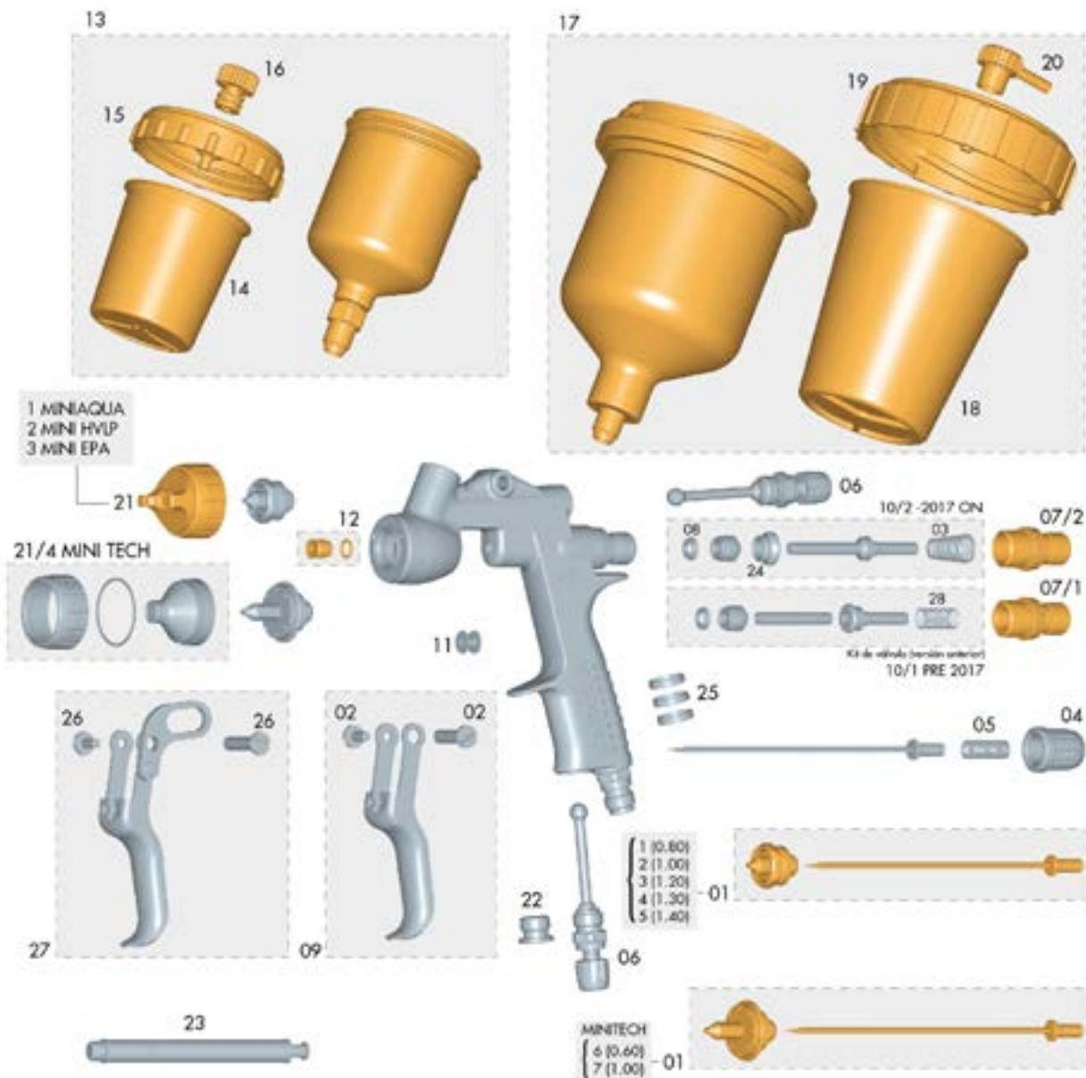
Nous appelons pièces d'usure celles qui peuvent arrêter le travail d'un pistolet: pièces durables, joints, packing gland,... La conception des pistolets Sagola propose **SEULEMENT 6 PIÈCES D'USURE** ( ■ ). Seulement 6 références en magasin pour assurer un SAV 100% efficace.
