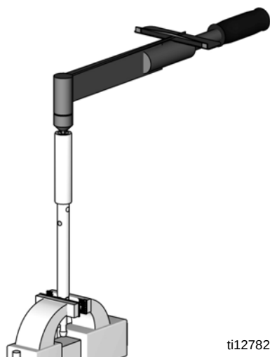
FIG. 2. Enlevez l'écrou de transit
