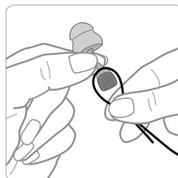
Pour fixer la cordelette, former une boucle et la mettre autour de la rainure de la tige.
