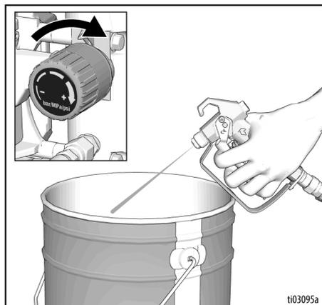
9. Tout en déclenchant le pistolet, soulever le tuyau d'aspiration au-dessus du liquide de rinçage pour purger le fluide du flexible. Maintenir la gâchette enfoncée jusqu'à ce que le fluide cesse de s'écouler.
