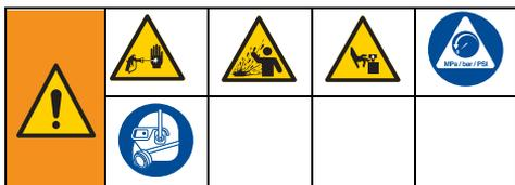
Cet équipement reste sous pression tant que la pression n'a pas été relâchée manuellement. Pour éviter les blessures graves provoquées par du liquide sous pression, comme des injections sous-cutanées, des projections de liquide ou pièces en mouvement, suivre la Procédure de décompression chaque fois que le pulvérisateur est arrêté, avant le nettoyage ou la vérification du pulvérisateur et avant tout entretien de l'équipement.
