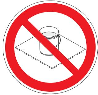
**Les seaux métalliques doivent être toujours mis à la terre :** raccorder un fil de terre au seau. Serrez une extrémité au seau et l'autre extrémité à une vraie prise de terre telle qu'un conduit d'eau.
