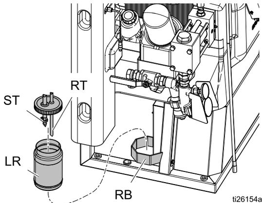
2. Remplissez avec du lubrifiant frais. Vissez le réservoir sur l'ensemble de capuchon et placez-le sur le support (RB).
