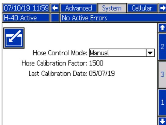
2. Sélectionnez Manuel dans le menu déroulant du Mode de commande du flexible.
