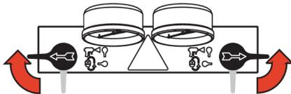
4. Appuyez sur
