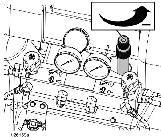
7. Appuyez sur
