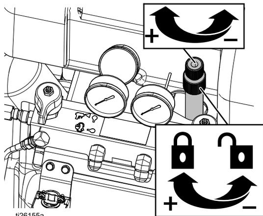
Les pressions de sortie des composants A et B seront plus élevées que la pression hydraulique en fonction du modèle. La pression des composants A et B (GA, GB) est visible sur les manomètres ou sur l'ADM.
