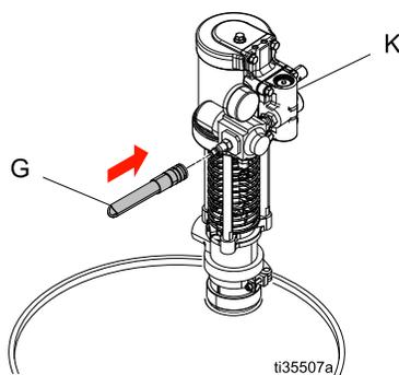
8. Réglez le bouton compensateur de la pression du doseur sur une pression inférieure à 34 bar (500 psi, 3,4 MPa).
