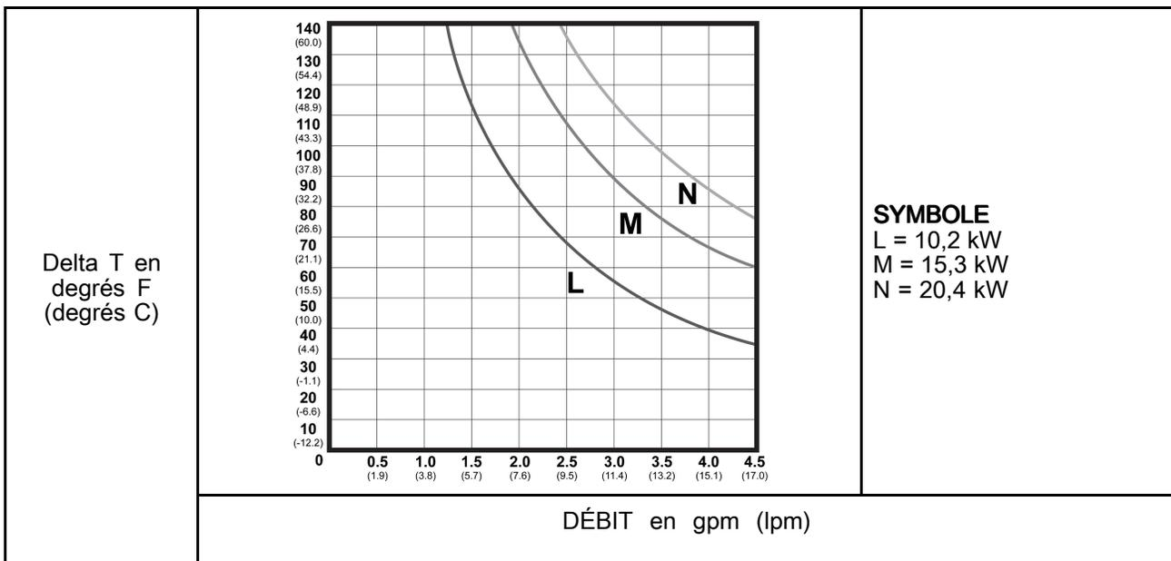
\* Les données de rendement du réchauffeur sont basées sur des essais avec de l'huile hydraulique 10 wt. et avec 230 V passant par les câbles d'alimentation électrique du réchauffeur.
