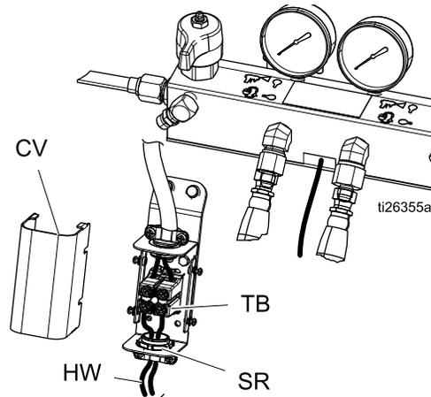
2. Faites passer les câbles du flexible chauffé (HW) par le serre-câble (SR) et placez les câbles dans les bornes à vis ouvertes du bornier (TB). Serrez à un couple de 3,95 N•m (35 po-lb).
