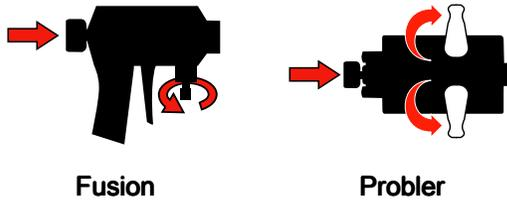
2. Fixez le collecteur de fluide du pistolet. Branchez la conduite d'air du pistolet. Ouvrez la vanne de la conduite d'air.
