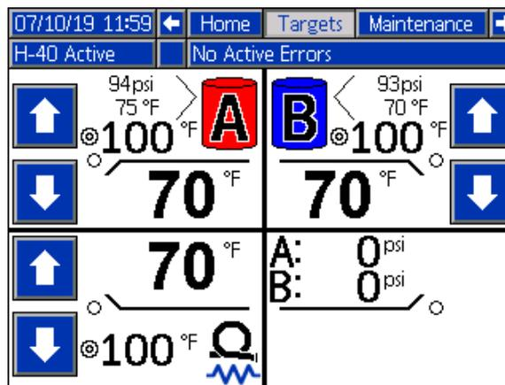
**REMARQUE** : Le mode Résistance du flexible régule la température moyenne du fluide des fluides A et B. Réglez le point de consigne de température du flexible à mi-chemin entre les points de consigne de température A et B et réglez de façon à obtenir les performances souhaitées.
