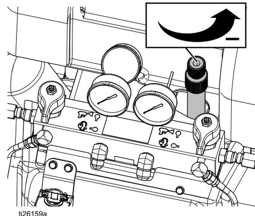
6. Appuyez sur pour mettre le moteur et les pompes en marche. Faites circuler le fluide à la pression la plus faible possible jusqu'à ce que les températures aient atteint leur niveau de consigne.
