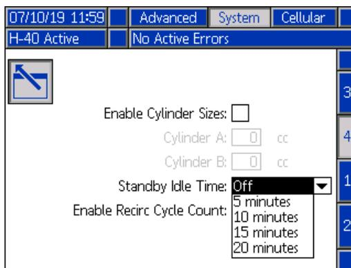
3. Sélectionnez Standby Idle Time (Durée d'immobilisation en veille) dans le menu déroulant avec et les touches fléchées. Sélectionnez le retard souhaité avec et les touches fléchées. Appuyez sur Entrée pour sélectionner la valeur désirée.
