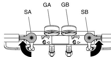
Pour rincer complètement le système, faites circuler le fluide par le collecteur de fluide du pistolet (après avoir retiré le pistolet du collecteur).
