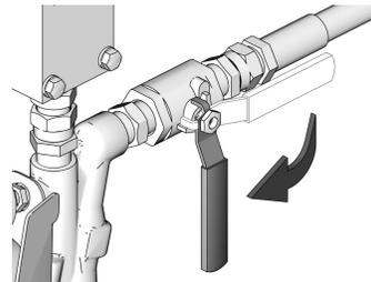
9. Réglez les vannes de DÉCOMPRESSION/PULVÉRISATION sur PULVÉRISATION pour contenir l'humidité de la conduite de vidange.
