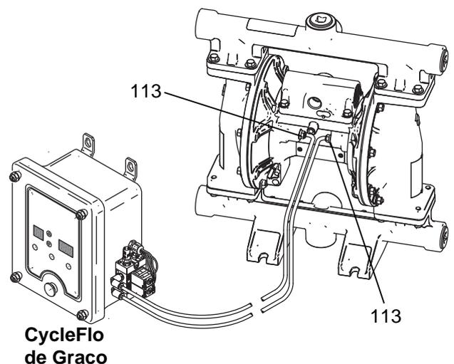
FIG. 2. Branchement du contrôle d'air à distance
