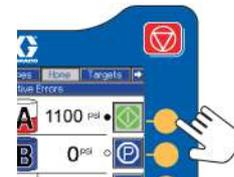
9. Contrôler les manomètres produit (GA, GB) pour s'assurer que l'équilibre de pression est correct. En cas de déséquilibre, réduisez la pression du composant le plus élevé en tournant **légèrement** la vanne de DÉCOMPRESSION/PULVÉRISATION de ce dernier
