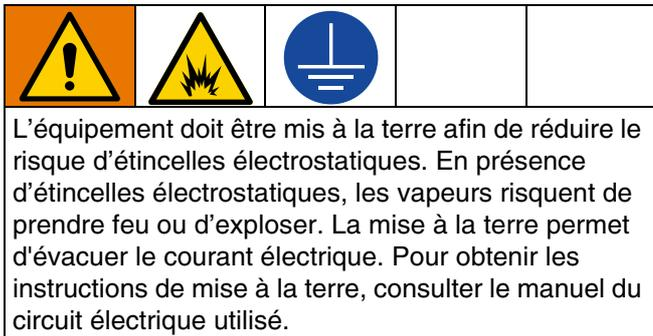
**Mettre le pistolet pulvérisateur Probler P2 à la terre :** le raccorder à un flexible de liquide correctement mis à la terre.
