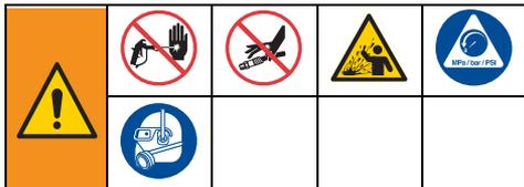
Cet équipement reste sous pression jusqu'à ce que la pression soit relâchée manuellement. Pour éviter de sérieuses blessures provoquées par du fluide sous pression, comme des injections sous-cutanées, des projections de produit ou pièces en mouvement, suivez la Procédure de décompression à chaque fois que le pulvérisateur est arrêté et avant le nettoyage ou la vérification de l'équipement a fait l'objet d'une réparation.
