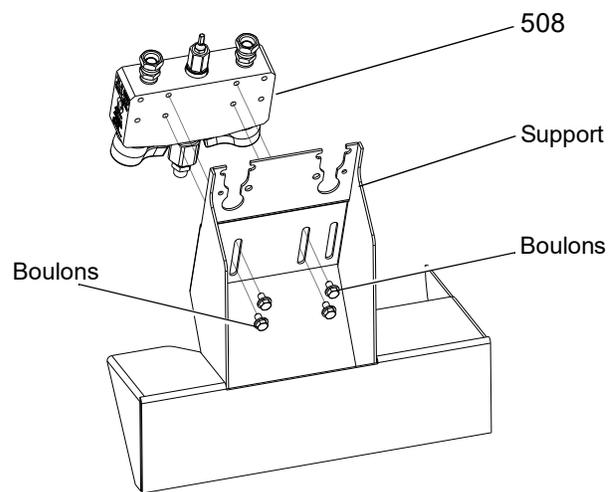
4. Dévisser les sièges du boîtier des vannes de dosage des adaptateurs du collecteur mélangeur.
