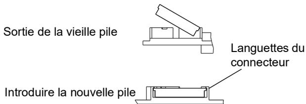
3. Remplacer par une nouvelle pile. Veiller à ce que la pile se loge sous les languettes du connecteur avant de cliqueter une autre extrémité en place.
