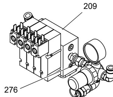
6. Réparer ou remplacer les pièces du régulateur de l'alternateur si nécessaire. Voir **Ensemble alternateur**, page 84, pour les pièces de réparation. Replacer le raccord tournant (276) du régulateur de débit d'air.
