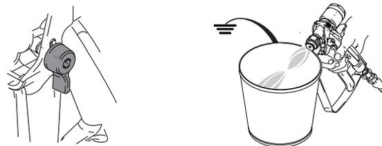
6. Fermer la vanne d'air (CB) de la pompe à solvant.
