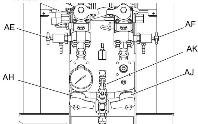
3. Ouvrir la vanne d'arrêt de solvant (AK) du collecteur mélangeur.
