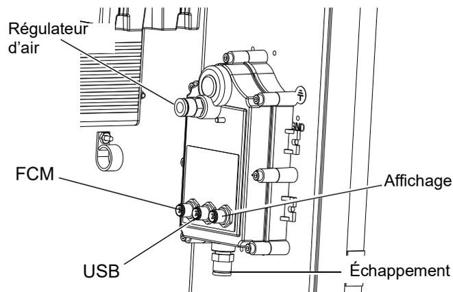
6. Débrancher la conduite d'air du régulateur d'air et la conduite d'air d'échappement.
