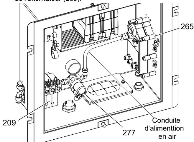
5. Desserrer le raccord (276) du raccord tournant du régulateur d'air et le retirer du module d'électrovanne (209).
