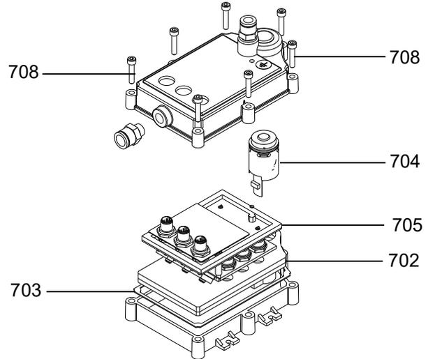
10. Remplacer le joint (702) et/ou l'ensemble de circuit imprimé (705) s'il est endommagé.
