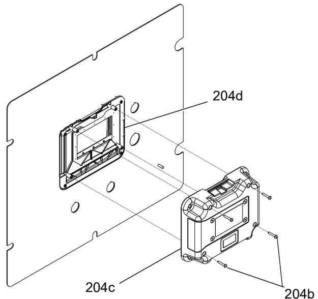
6. Retirer le panneau d'affichage arrière (204c) et débrancher le câble de l'écran et le câble de l'interrupteur principal (239) du circuit imprimé.
