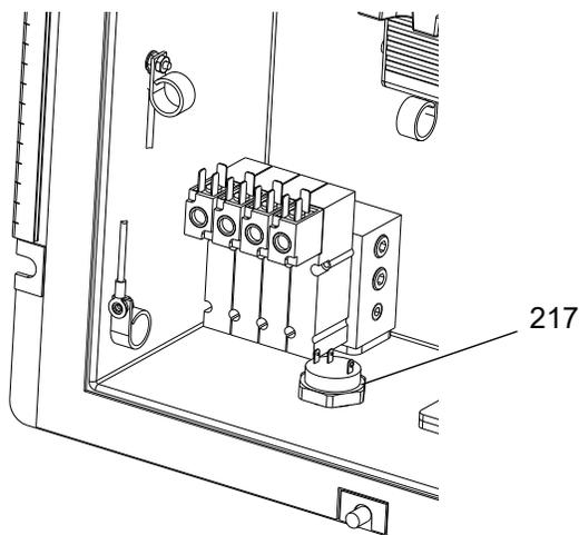
6. Visser la nouvelle alarme. Raccorder de nouveau les fils de l'alarme. Se reporter à la section **Pièces**, page 59.
