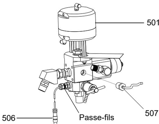
6. Remplacer par un nouveau capteur de pression de produit et raccorder de nouveau le capteur de pression au FCM.
