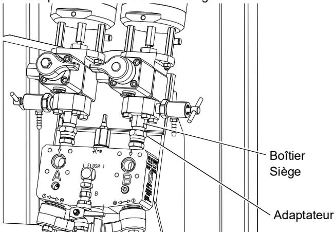
5. Débrancher le DTR (506) du presse-étoupe. Débrancher capteur de pression (507) et l'adaptateur de la conduite de produit à partir de chaque vanne de dosage (501).
