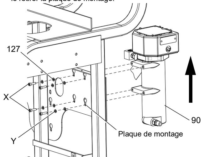
3. Remplacer le chauffage. Suivre les étapes dans l'ordre inverse pour installer un nouveau réchauffeur.
