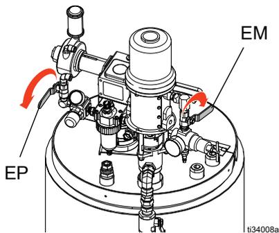
11. Faites fonctionner les principales pompes à fluide haute pression jusqu'à ce que le produit soit vidé du système,
