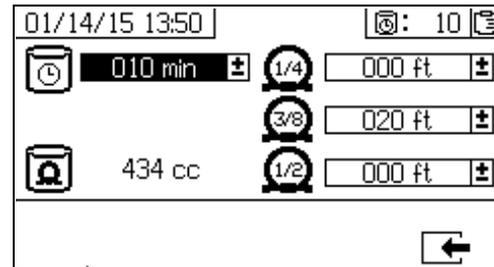
Cet écran permet aux utilisateurs de paramétrer le minuteur de durée de vie du produit et la longueur de chaque flexible de produit mélangé raccordé au système. Le volume total de produit mélangé est alors calculé et affiché sur la page. La durée de vie du produit est affichée dans le coin supérieur droit.
