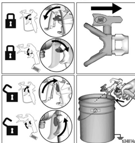
**REMARQUE** : Si la buse de pulvérisation est difficile à articuler en tournant vers UNCLOG (Débouchage), suivre la procédure **Procédure de dépressurisation**, page 19, puis mettre la vanne d'amorçage/de pulvérisation en position pulvérisation (SPRAY) et répéter l'étape 1.
