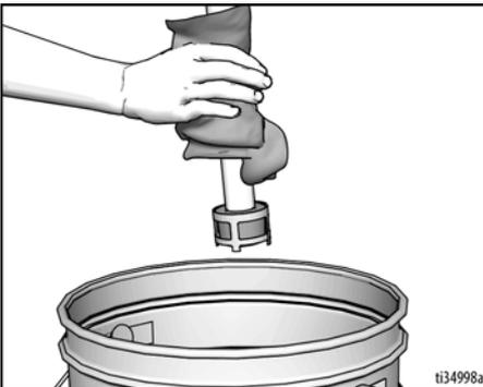
4. Plonger le tuyau d'aspiration dans un liquide de rinçage adapté. Mettre le tuyau de vidange dans le seau à déchets.
