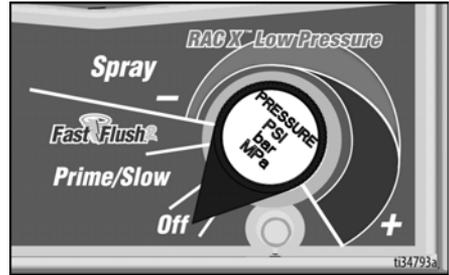
4. Mettre le tuyau de vidange dans le seau à déchets et tourner la vanne d'amorçage/de pulvérisation vers **PRIME** (Amorçage) pour relâcher la pression.
