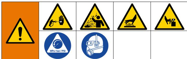
Cet équipement reste sous pression tant que la pression n'a pas été relâchée manuellement. Pour éviter de sérieuses blessures provoquées par du produit sous pression, comme des injections sous-cutanées, des éclaboussures de produit et des pièces en mouvement, exécuter la procédure de décompression lorsque l'on arrête la pulvérisation et avant de procéder à un nettoyage, à une vérification ou à un entretien de l'équipement.
