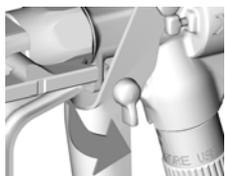
2. Tirer sur le bouton de réglage de la pression (H) pour le sortir et le tourner dans le sens inverse des aiguilles d'une montre jusqu'à sa butée. Enfoncer le bouton pour le verrouiller.
